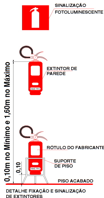
Figura 1 - Fixação de extintor
